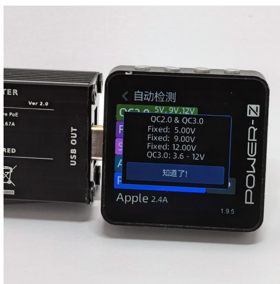
Power-Z-Testfotos. Links: USB-C-PD-3.0-Profil und beide PPS-Bereiche. Rechts: erkannte QC-2.0/3.0-Spannungsmodi.
