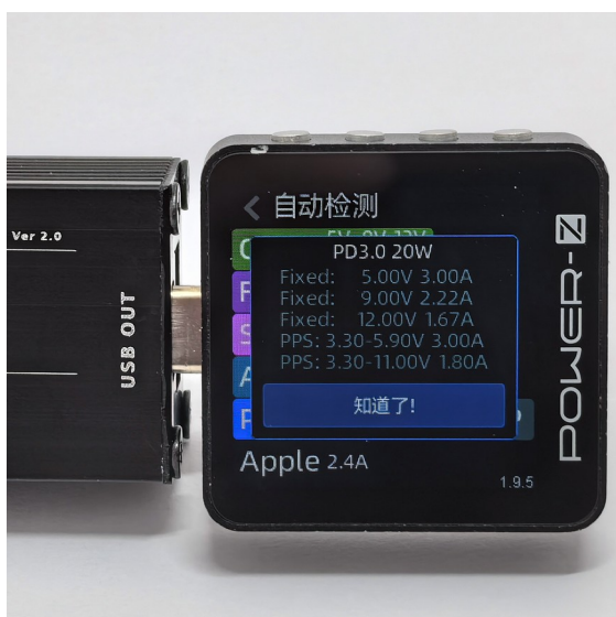
Photos de test Power-Z. À gauche : profils USB-C PD 3.0 et les deux plages PPS. À droite : modes de tension QC 2.0/3.0 détectés.
