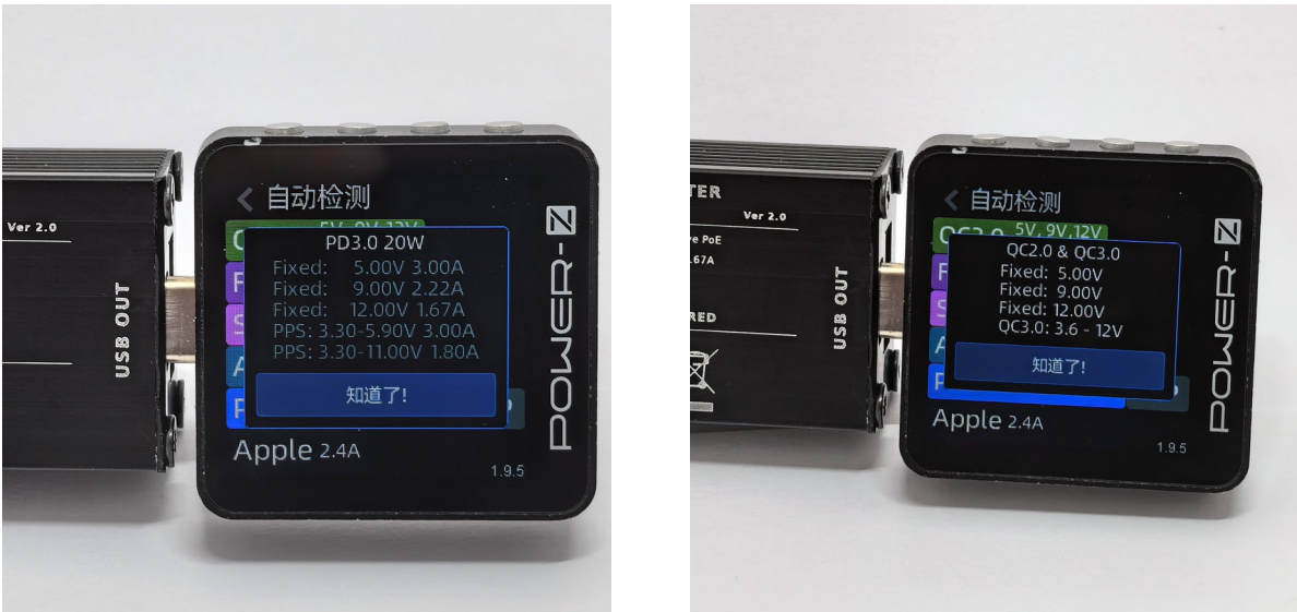
Foto dei test Power-Z. Sinistra: profili USB-C PD 3.0 ed entrambi gli intervalli PPS. Destra: modalità di tensione QC 2.0/3.0 rilevate.
