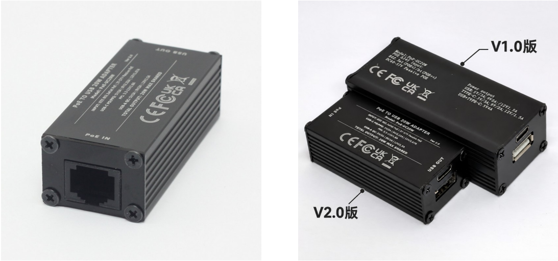
Sinistra: ingresso RJ45 PoE IN. Destra: V2.0 davanti e precedente V1.0 dietro; USB-C e USB-A si trovano sul lato USB OUT. L'adattatore fornisce solo alimentazione USB e non trasmette dati Ethernet.
