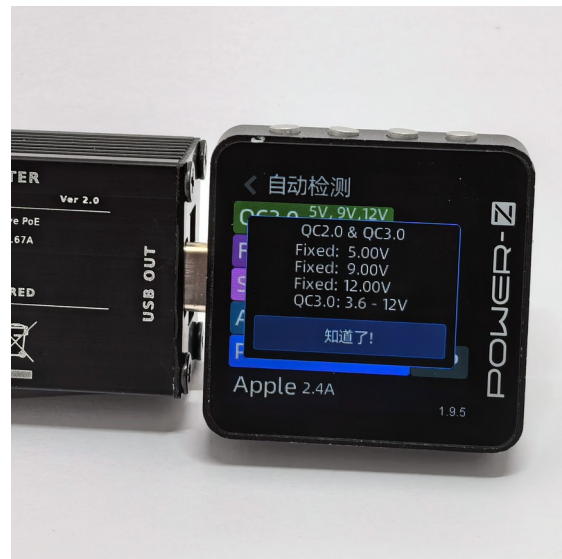
Power-Z 테스트 사진. 왼쪽: USB-C PD 3.0 프로파일 및 두 PPS 범위. 오른쪽: 감지된 QC 2.0/3.0 전압 모드.
