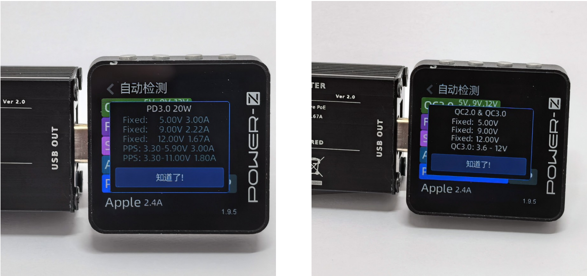
Power-Z 实测照片。左：USB-C PD 3.0 固定档位及两组 PPS 范围。右：检测到的 QC 2.0/3.0 电压模式。
