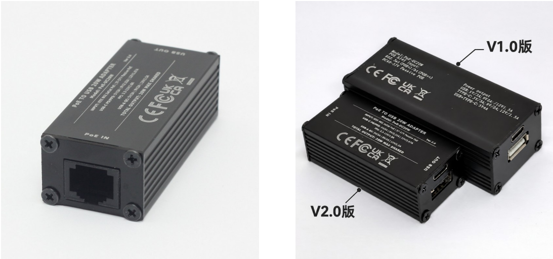
左图：RJ45 PoE 输入端。右图：前方为 V2.0，后方为旧版 V1.0；USB 输出端具有 USB-C 和 USB-A 接口。本产品仅输出 USB 电源，不传输以太网数据。
