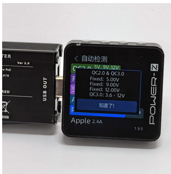
Power-Z 實測照片。左：USB-C PD 3.0 固定檔位及兩組 PPS 範圍。右：檢測到的 QC 2.0/3.0 電壓模式。
