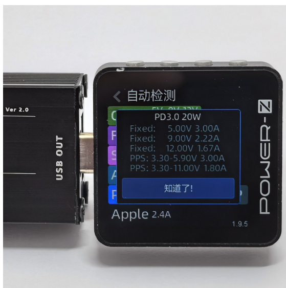
Power-Z 實測照片。左：USB-C PD 3.0 固定檔位及兩組 PPS 範圍。右：檢測到的 QC 2.0/3.0 電壓模式。
